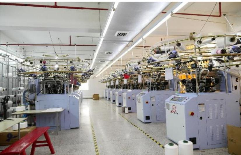
提出了基于OPC UA通信规范的针织机械信息化模型，研制了符合联网通信规范的针织机械控制器，开发了接口/协议转换网关，实现了现役设备的无缝网络接入
