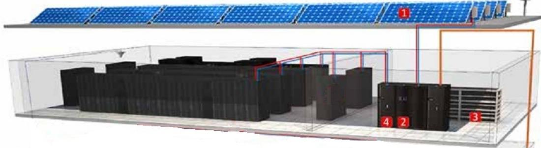
1 光伏发电单元 2 高压直流单元 3 储能单元 4 配电及保护单元
